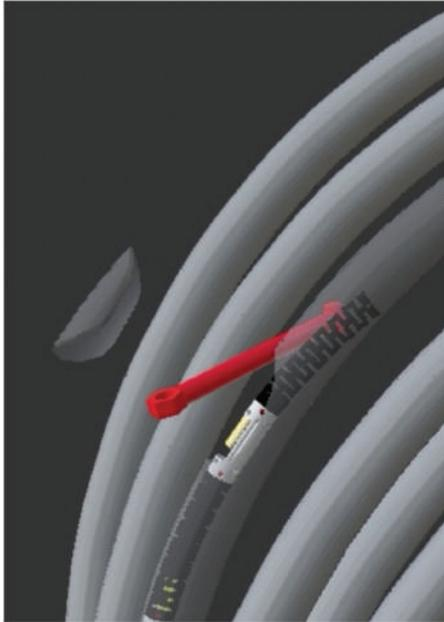
EDM end tool 장비는 방전 가공이 실제로 수행되는 말단 장치로 사용되며, 장치 상단에 위치한 전극과 열교환 튜브 내벽(작업 대상) 간의 방전을 유도합니다. 이를 통해 증기 발생기의 열교환 튜브에 개구부를 생성할 수 있습니다. 회전 각도 조절이 완료되면 하단 장치의 고정 부품이 활성화되어 오링을 열교환 튜브의 내벽에 부착하며, 장치를 튜브 내벽에 견고하게 고정합니다. 방전 가공 유체를 공급하는 동안 전극은 왕복 운동을 통해 100 $\mu$ m 이하의 방전 잔여물을 생성하며, 이 과정에서 우측 사진과 같이 원하는 크기, 원하는 모양의 개구부를 형성합니다.
